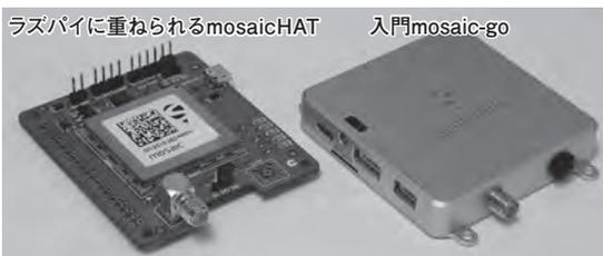
写真1 測量用受信機並みの受信能力で数万円台と低コストになった受信モジュールmosaic(セプテントリオ)の搭載製品
