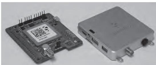
写真1 測量用受信機並みの受信能力で数万円台と低コストになった受信モジュール mosaic(セプテントリオ)の搭載基板 ラズベリー・パイと組み合わせやすい基板の mosaicHAT と、ケース入り評価キットの mosaic-go
