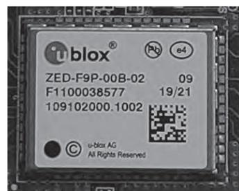
写真3 2波長受信GPSモジュールZED-F9P(ユーブックス製)
