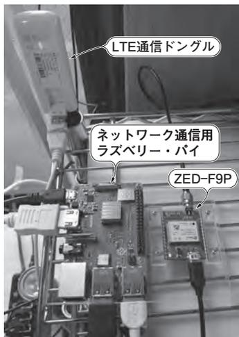
写真1 ラズベリー・パイと定番ZED-F9Pを使ってRTK基準局を作る
