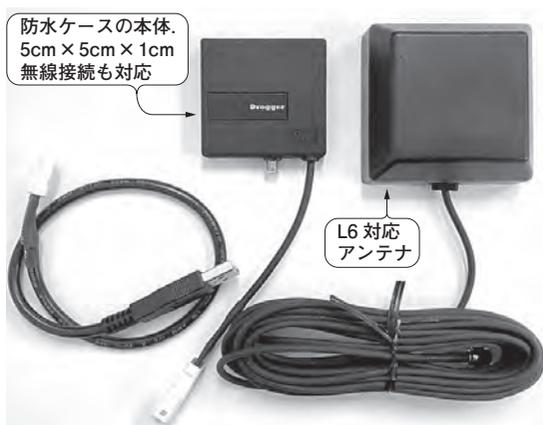
写真1 CLAS信号の受信機VRSC(図1左側)…仮定の基準局データを計算して出力する
